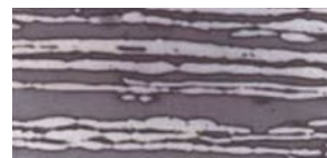
Microstructure du DX2205 (la phase ferritique apparaît en sombre)
